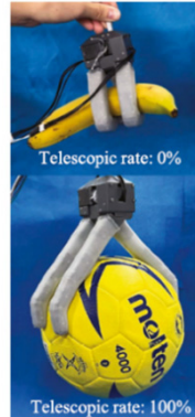
伸縮機能を持つハンド Telescopic rate: 0% Telescopic rate: 100%
