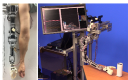
7自由度, 可搬重量1.5kg, 自重2.2kg, (世界最軽量)
